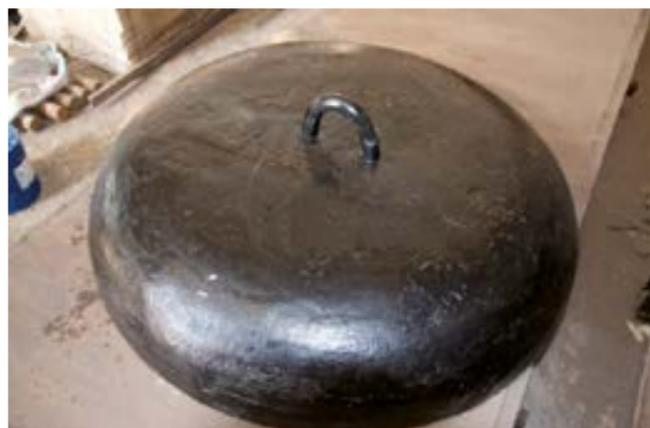
Якоря применяют для установок бочек, плавучих маяков, буев, вех и других неподвижных плавучих сооружений.
