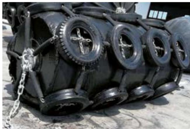
**Пенополненный кранец** – идеальное решение для штормовых условий, которое может превзойти кранцы швартовые пневматические в суровых погодных условиях. Так как внутренняя конструкция состоит из твердого пенопластового наполнения, нет необходимости поддерживать давление воздуха. Кранцы исключительно надежны в эксплуатации, рабочие характеристики не снижаются в случае их повреждения. При необходимости кранец может быть оборудован шинно-цепной обвязкой.
