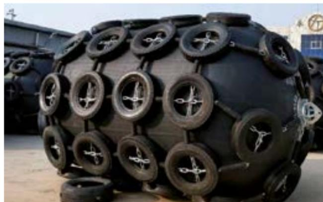
янке отшвартованных судов при ведении перегрузочных операций в условиях открытого моря при температуре окружающего воздуха от минус 30 до плюс 45 ОС и волнения моря до 7 баллов. При швартовочных операциях кранец находится на плаву в подвешенном состоянии между бортами швартующих судов.
