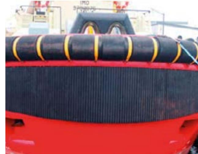
Кранцы такой формы обеспечивают большие контактные поверхности с целью уменьшения давления на корпус. Рифленные поверхности обеспечивают отличное сцепление.
