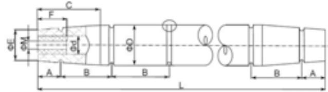
Носовое кранцевое цилиндрическое устройство часто используется в качестве передних толкающих кранцев на носовой части или корме современных буксиров. Их закругленная форма идеально подходит для работы с судами с большим развалом бортов в носу (контейнеровозы), а также хорошо подходит для толкания судов с плоскими бортами.
